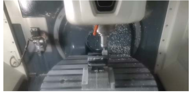
Fig. 4. Deneme Parçasının Frezelenmesi
